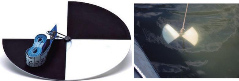
Figura 25: Fotografia do Disco de Secchi, equipamento circular com quatro divisões equivalentes, sendo duas de cor preta e duas de cor branca, com uma fita métrica, utilizado para mensurar a transparência de viveiros de piscicultura.
