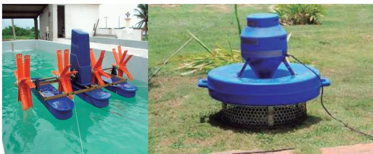
Figura 26: Fotografia de aeradores utilizados na piscicultura. À esquerda, está apresentado um aerador de superfície (de pá) e à direita um aerador tipo chafariz.
