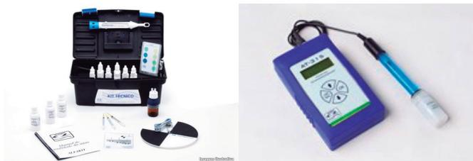
Figura 30. A Ilustração à esquerda pode ser visualizado um Kit da empresa Alfakit® para monitorar os parâmetros de qualidade de água, incluindo teste para pH por metodologia colorimétrica; à direita pode ser visualizado um aparelho eletrônico, pHmetro da empresa Alfakit® para mensurar o pH da água.
