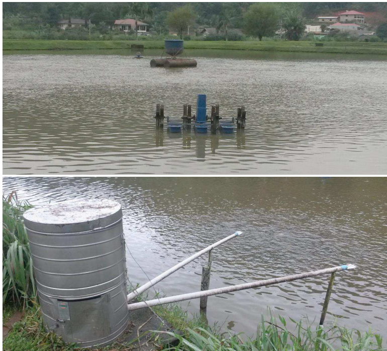
Figura 8.15. Alimentador automático e aerador utilizados no Polo de Santa Catarina.
