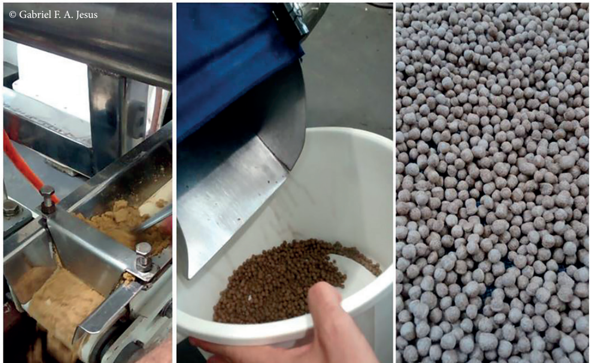
Figura 3. Preparo de ração experimental extrusada, no Laboratório de Nutrição de Espécies Aquícolas – LABNUTRI/UFSC, contendo diferentes porcentagens de inclusão de sais orgânicos.
