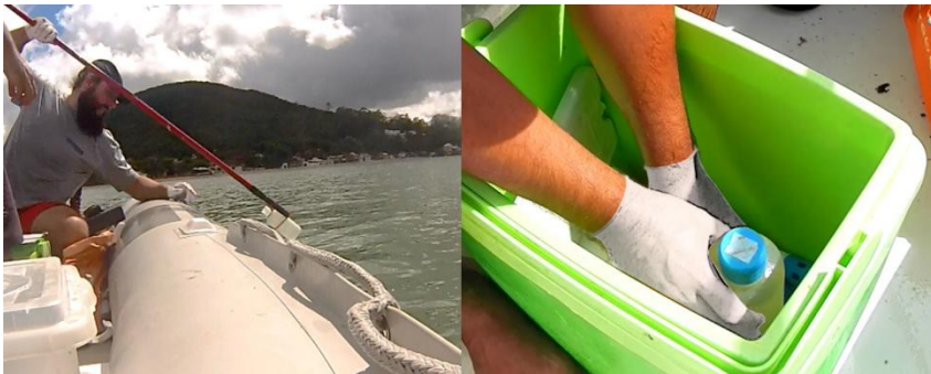
Figura 9. Coleta de água marinha para análises microbiológicas
