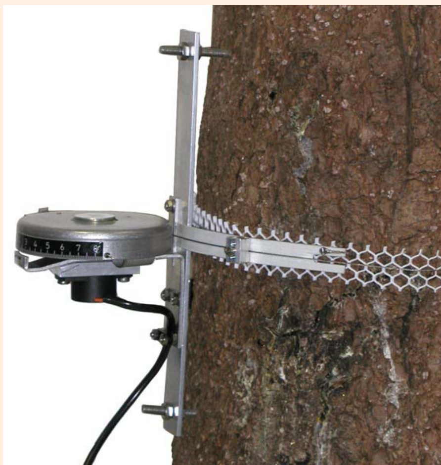
Figura 2. Ilustração de faixas dendrométricas instaladas em Araucaria angustifolia (Bertol.) Kuntze
