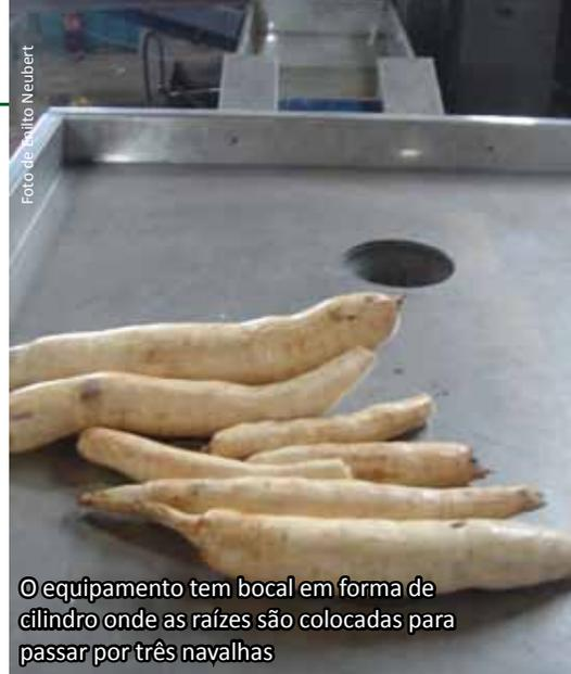
© equipamento tem bocal em forma de cilindro onde as raízes são colocadas para passar por três navalhas
