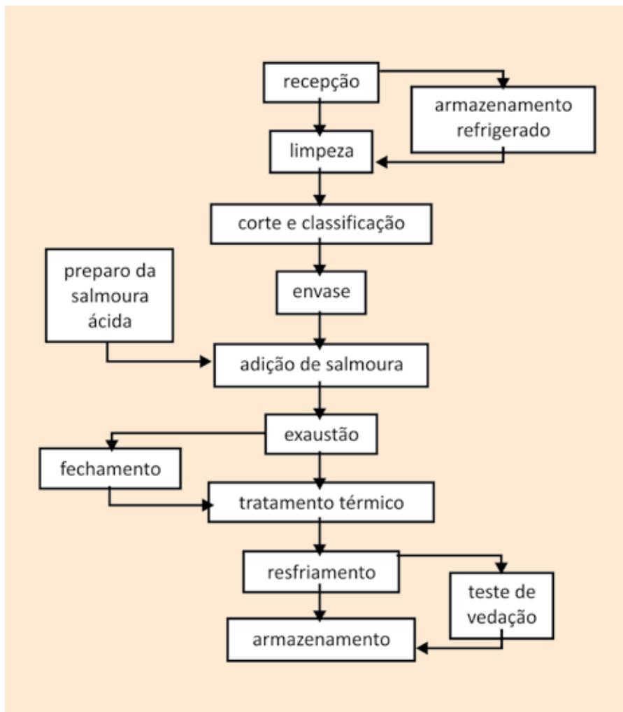
Figura 1. Diagrama do processo de produção das conservas de vagem e de S. perennis em aproximadamente 100°C por 30 minutos
